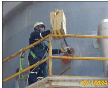
รูปที่ 3-12 การติดตามตรวจสอบคุณภาพอากาศ จากปล่องของโรงงานปูนฯ บริเวณ Main Stack ของสายการผลิตที่ 4
